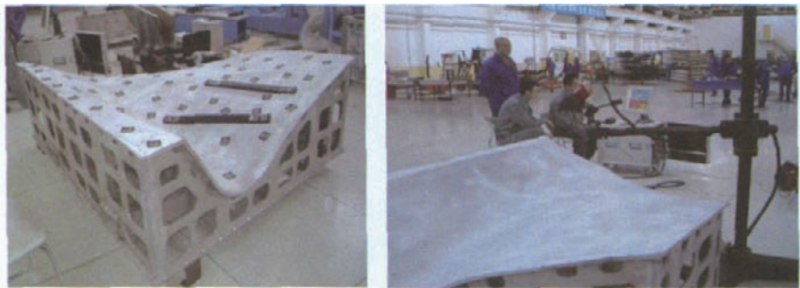
图2 波音飞机机翼模具三维测量现场
